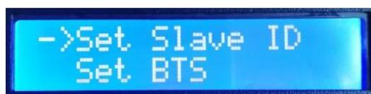
2.2. 再按“SET”键，主控显示进入编号页面，“速度+/SPEED+”按键和“速度-/SPEED-”按键调整设置起始分控的编号数字，如下图：
