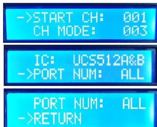
2.4. 按“MODE”键移动箭头对应项目，按“SPEED+”和“SPEED-”分别设定起始通道/间隔通道/IC选项/写址端口。
