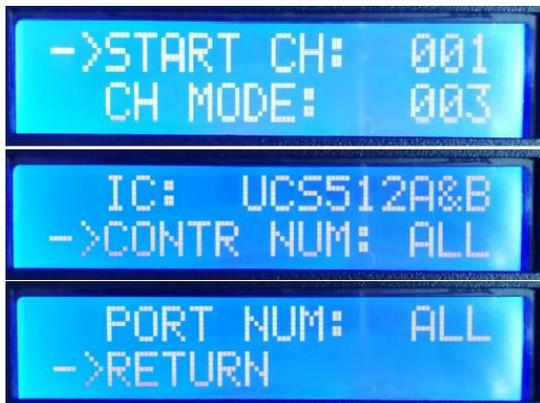
10.3. 按 “MODE” 键移动箭头各个，按 “SPEED+” 和 “SPEED-” 分别设定起始通道/间隔通道 /IC 选项/选择写址控制器/选择写址端口。
