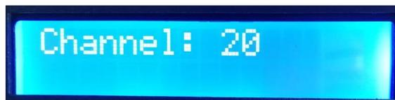
8.3. “速度+/SPEED+”按键和“速度-/SPEED-”按键调整射频频段（建议设置20-25），“MODE”按键确认选择。
