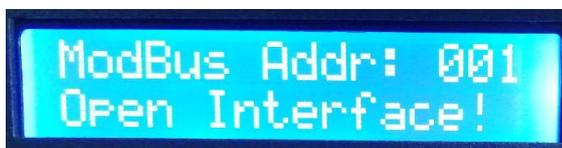
7.3. “速度+/SPEED+”按键和“速度-/SPEED-”按键调整编号数字设置控制器编号；再按“MODE”按键确认选择，第三方设备控制开启，显示如下图：
